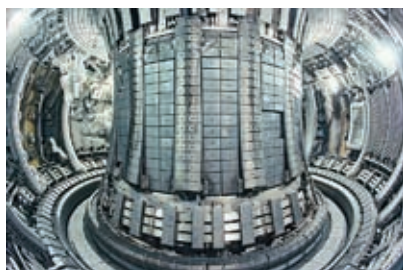
13. En esta cámara de un tokamak puede confinarse plasma a altas temperaturas, lo que sirve para investigar la viabilidad de la fusión nuclear.
